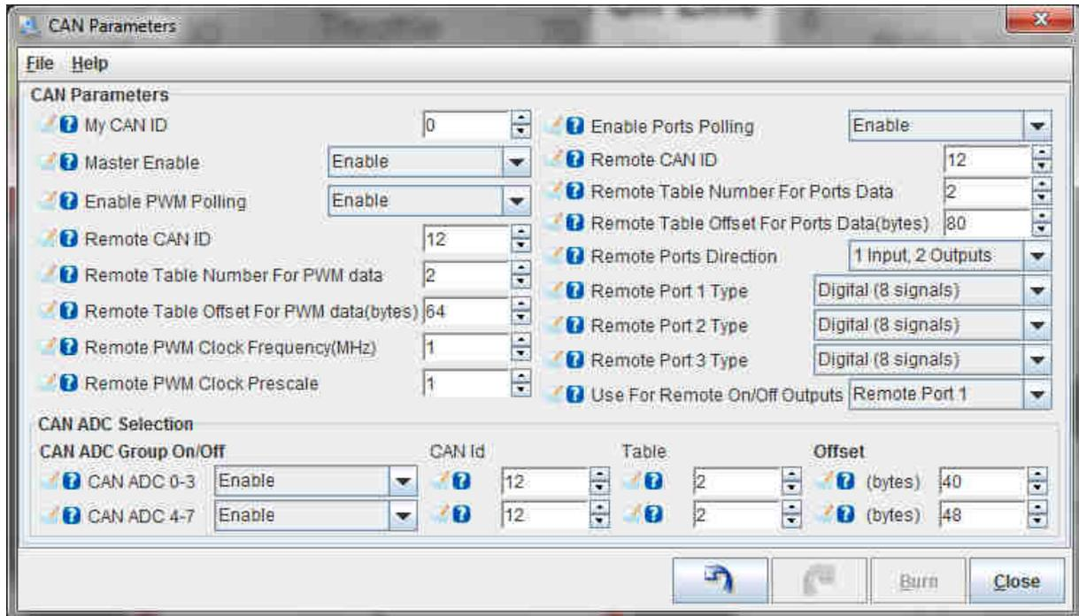
Da bei einer MS2 nur 8 Can Bus ADC variablen zur Verfügung stehen kann hier leider nicht der volle Umfang der Platine genutzt werden.
